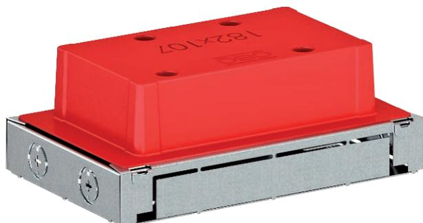
Монтажное основание для монтажа в полу с монтажным отверстием от 106 x 182 мм для лючка номинального размера 2. Монтажное отверстие изготавливается с помощью опалубки, которая входит в комплект поставки. Монтажное основание имеет отверстия для двух электромонтажных труб M20 на лицевой стороне. Подходит для использования в бесшовных полах с цементной стяжкой с установочной высотой от 70 до 90 мм.
