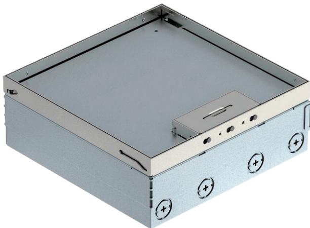
Квадратный лючок для установки в стяжке и в пустотном полу с сухим типом уборки в помещениях. Корпус с отверстиями для ввода труб (M25). Верхняя часть выравнивается по поверхности напольного покрытия с помощью 4-х регулируемых опор. Откидная крышка с выемкой толщиной 15 мм для фрагмента напольного покрытия. Минимальная монтажная глубина составляет 95 мм, диапазон регулирования по высоте + 30 мм.
