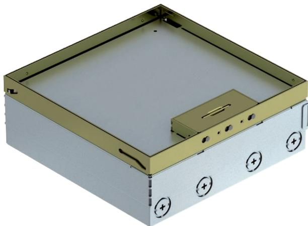
Квадратный лючок для установки в стяжке и в пустотном полу с сухим типом уборки в помещениях. Корпус с отверстиями для ввода труб (M25). Верхняя часть выравнивается по поверхности напольного покрытия с помощью 4-х регулируемых опор. Минимальная монтажная глубина составляет 95 мм, диапазон регулирования по высоте + 30 мм.
