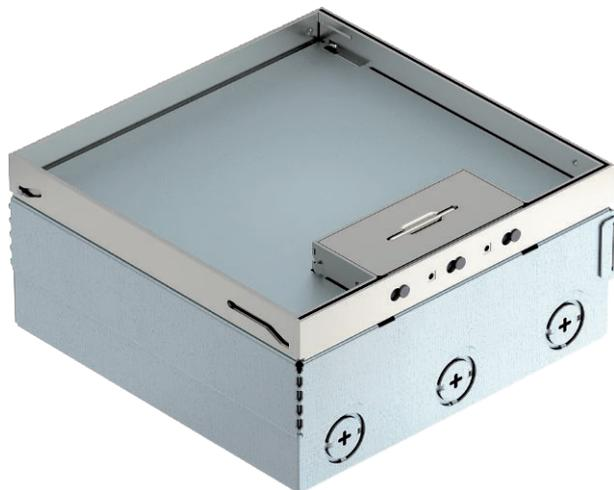
Квадратный лючок для установки в стяжке и в пустотном полу с сухим типом уборки в помещениях. Корпус с отверстиями для ввода труб (M25). Верхняя часть выравнивается по поверхности напольного покрытия с помощью 4-х регулируемых опор. Минимальная монтажная глубина составляет 95 мм, диапазон регулирования по высоте + 30 мм.
