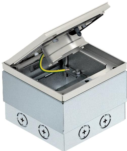
Квадратный лючок для установки в стяжке и в фальшполу с сухим типом уборки пола. Корпус со штампованными отверстиями для ввода труб (M20/M25). Верхняя часть выравнивается по поверхности напольного покрытия с помощью 4-х регулируемых опор. Минимальная монтажная глубина составляет 110 мм, диапазон регулирования + 20 мм.
