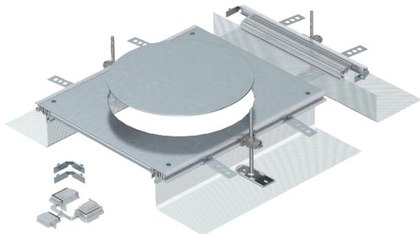
Монтажная секция кабельного канала с крышкой для установки лючка номинального размера R9; состоит из боковых профилей с гибкой стенкой из металлоткани, стыковочных профилей, крышки канала с закрытым монтажным отверстием и торцевой заглушки. В комплект входит с 3 регулируемых крепежных уголка, 3 анкера для стяжки, 1 опора крышки (без регулируемой по высоте опоры, которую необходимо заказать отдельно) и 1 комплект для ответвления 90°.
