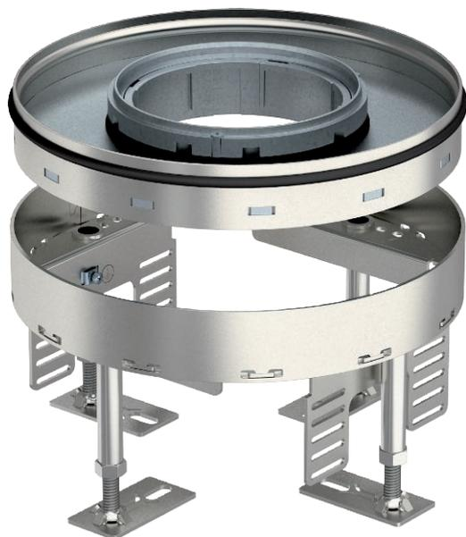
Круглая кассета для больших нагрузок для трубы, номинального размера R4 для монтажа электроустановочных изделий в системах каналов, двойных и пустотных полах с сухим или влажным типом уборки во внутренних помещениях. Класс нагрузки от 2 до 20 кН.
