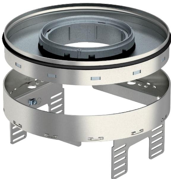
Регулируемая по высоте, отсоединяемая от пола кассета номинального размера R4, для трубы, для монтажа электроустановочных изделий в полах с сухим или влажным типом уборки во внутренних помещениях, для монтажа в подпольные розетки UZD250-3 или UZD350-3, каждая в комбинации с монтажной крышкой DUG..R4, или в UGD250-3R4 или UGD350-3R4. Устанавливается с помощью нивелирующих углов (заказываются отдельно) в корпусе монтажного основания под заливку в бетон.
