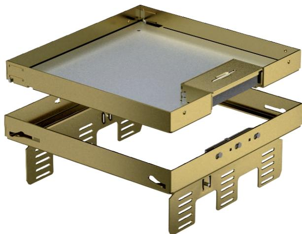
Регулируемая по высоте, отсоединяемая от пола кассета номинального размера 9, с выпуском кабеля, для монтажа электроустановочных изделий в полах с сухим типом уборки во внутренних помещениях, для монтажа в подпольных розетках UZD250-3 или UZD350-3, каждая в сочетании с монтажной крышкой DUG../9, или в UGD250-3/9 или UGD350-3/9. Устанавливается с помощью нивелирующих углов (заказываются отдельно) в корпусе монтажного основания под заливку в бетон.
