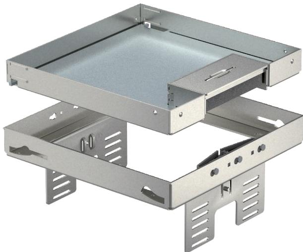
Регулируемая по высоте, отсоединяемая от пола кассета номинального размера 4, с выпуском кабеля, для монтажа электроустановочных изделий в полах с сухим типом уборки во внутренних помещениях, для монтажа в подпольных розетках UZD250-3 или UZD350-3, каждая в сочетании с монтажной крышкой DUG../4, или в UGD250-3/4 или UGD350-3/4. Устанавливается с помощью нивелирующих углов (заказываются отдельно) в корпусе монтажного основания под заливку в бетон.
