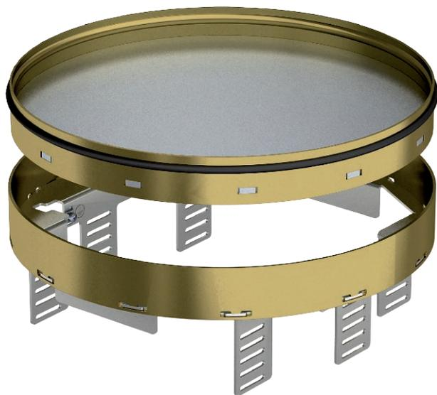
Регулируемая по высоте, отсоединяемая от пола кассета, глухая, для формирования ревизионного отверстия номинального размера R7 в полах с сухим или влажным типом уборки во внутренних помещениях, для монтажа в подпольные розетки UZD350-3, в комбинации с одной монтажной крышкой DUG350-3R7, или в UGD350-3R7. Устанавливается с помощью нивелирующих углов (заказываются отдельно) в корпусе монтажного основания под заливку в бетон. Подходит только для гладких напольных покрытий.
