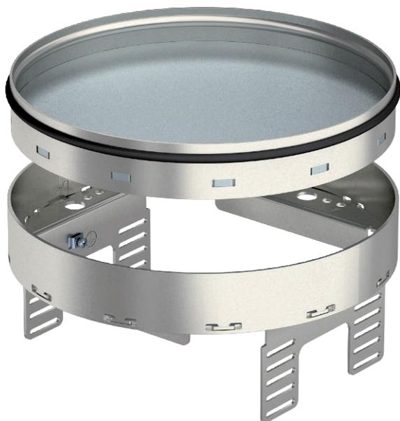
Регулируемая по высоте, отсоединяемая от пола кассета, глухая, для формирования ревизионного отверстия номинального размера R4 в полах с сухим или влажным типом уборки во внутренних помещениях, для монтажа в подпольные розетки UZD250-3 или UZD350-3, каждая в комбинации с монтажной крышкой DUG..R4, или в UGD250-3R4 или UGD350-3R4. Устанавливается с помощью нивелирующих углов (заказываются отдельно) в корпусе монтажного основания под заливку в бетон. Подходит только для гладких напольных покрытий.
