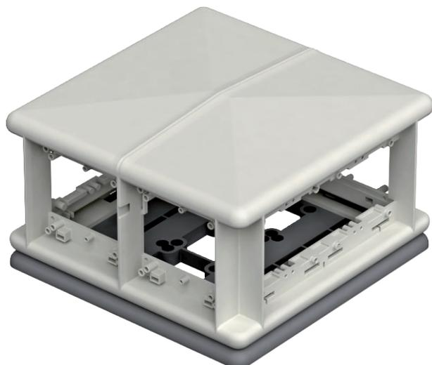
Напольный бокс для монтажа 8 отдельных электроустановочных изделий с суппортом с 4 сторон. Разделение разных групп электроснабжения (4 + 4) осуществляется с помощью разделительной перегородки. При использовании электроустановочных изделий с несколькими вводами можно увеличить количество внешних подключений. Расстояние между крепежными винтами электроустановочных изделий: 60 мм, вертикальное.
