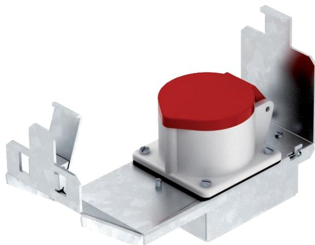
Монтажная рамка номинального размера 3 для установки розетки CEE 16 А или 32 А, для монтажа в лючках и кассетных рамках номинального размера R7, 9 и R9. В комплекте с защитным кожухом и фиксатором для разгрузки кабеля от натяжения. Минимальная монтажная глубина: 190 мм.
