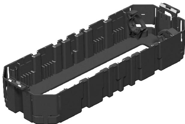
Монтажная коробка пустая, с 2 фиксаторами для разгрузки от натяжения входящих и исходящих проводов. С большим отверстием в основании для подвода кабеля к коммуникационным розеткам. Подходит для монтажа максимум 3 стандартных розеток или 4 устройств серии Modul45® в накладках.
