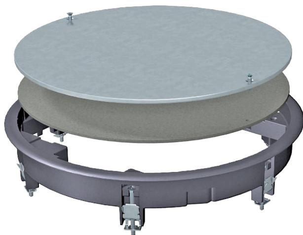
Вставка в коробку для потайной заглушки круглого монтажного отверстия номинального размера R7 в системах каналов, а также двойных и пустотных полах во внутренних помещениях. С универсальным крепежным углом. Защитная рамка из алюминиевого литья под давлением.
