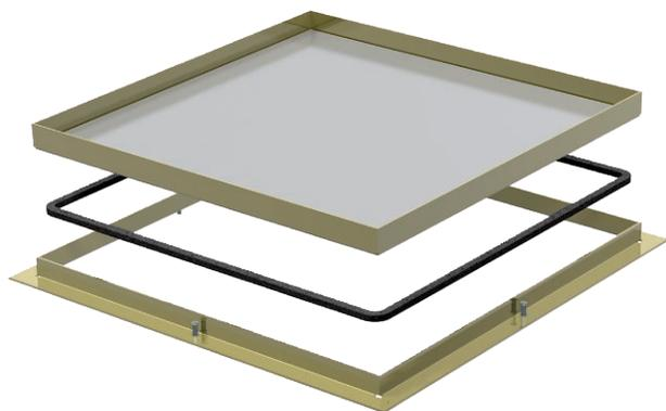
Кассетная рамка, глухая, для формирования ревизионного отверстия в UZD250-3 в полах с сухим или влажным типом уборки во внутренних помещениях. Подходит только для гладких напольных покрытий.
