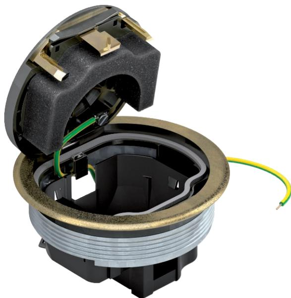
Круглый лючок с защитной рамкой для напольного покрытия, для установки в монтажное основание UDL2-120. При закрытом лючке допускается влажный тип уборки. Минимальная монтажная глубина составляет 70 мм. Накладка и розетки серии Modul45 заказываются отдельно.
