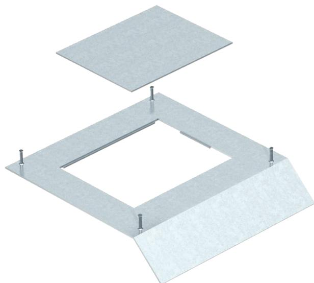
Крышка для основания кабельного канала AIK/U с монтажным отверстием для установки лючка номинального размера 6. Монтажное отверстие закрыто 2-миллиметровой алюминиевой заглушкой. Крышка кабельного канала прочно крепится с помощью винтов к алюминиевым боковым профилям его основания. Боковые поверхности крышки скошены на 45°.
