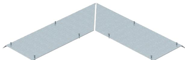
Крышка из 2-х частей для внешнего угла напольного канала, подходит для основания кабельного канала AIK/U, с 10 крепежными винтами. Крышка кабельного канала прочно привинчивается к алюминиевым боковым профилям его основания. Боковые поверхности крышки скошены на 45°.
