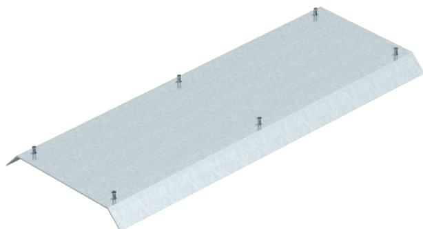
Крышка ответвления напольного кабельного канала АИКА подходит для основания канала АИК/У. Крышка канала крепится с помощью винтов к алюминиевым боковым профилям его основания. Боковые поверхности крышки с обеих сторон скошены на 45°.
