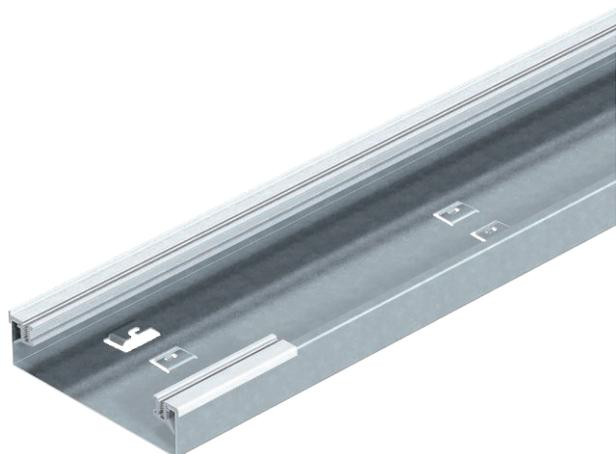
Основание 1-секционного напольного кабельного канала, для заглушек/монтажных крышек с фасками с одной стороны, с насаживаемыми алюминиевыми боковыми профилями для установки и крепления крышки канала, корпус с накладками для максимум 2 вставных полочек, образующих гальванический контакт, и углублением для клеммы подключения заземляющего провода. Высота канала подходит для монтажа напольных боксов Telitank.
