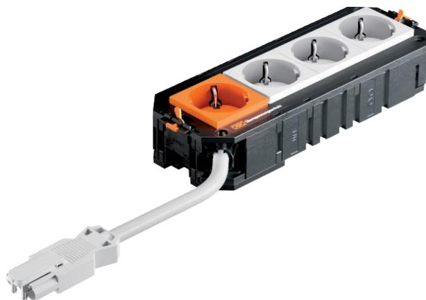
Укомплектованная монтажная коробка UTC4 с соединительным кабелем без галогенов. Она оснащена тремя розетками 33° с защитным контактом белого цвета и одной розеткой 33° с защитным контактом 16А оранжевого цвета. Оранжевые розетки подключены к модулю защиты от перенапряжений типа 3 согласно стандарту DIN EN 61643-11. Подходит для подключения кабелей VL и лючков номинальных размеров R7, R9 и 9.
