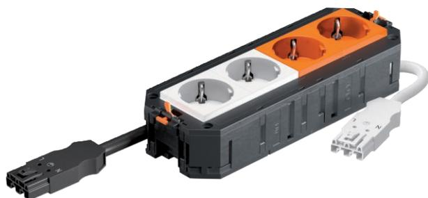
Укомплектованная монтажная коробка UTC4 оснащена 2 розетками 33° с защитным контактом белого цвета, и 2 розетками 33° с защитным контактом оранжевого цвета, 250 В ~ 16 А. Подходит к соединительным проводам VL и монтажным лючкам номинальных размеров 2, 4, R4 и R7.
