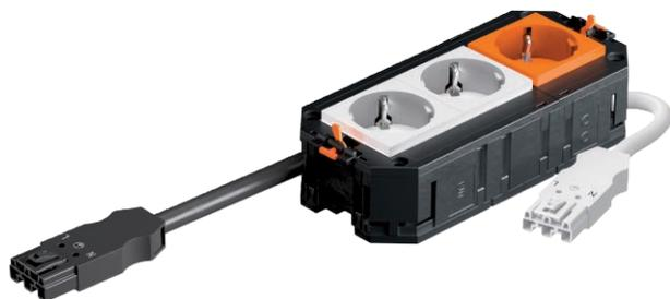
Укомплектованная монтажная коробка UTC3 оснащена 2 розетками 33° с защитным контактом белого цвета, 16 А, и одной розеткой 33° с защитным контактом оранжевого цвета, 16 А. Подходит к соединительным проводам VL и монтажным лючкам номинальных размеров 2, 4, R4 и R7.
