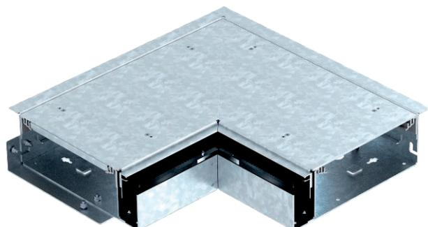
Внешний угол, состоит из основания кабельного канала, двух крышек и регулируемых по высоте боковых профилей. Щеточная планка, предусмотренная для вывода кабеля, расположена с боковой стороны. В комплект входит уплотнитель для крышки и соединитель; для регулирования высоты необходимо пять регулируемых опор.
