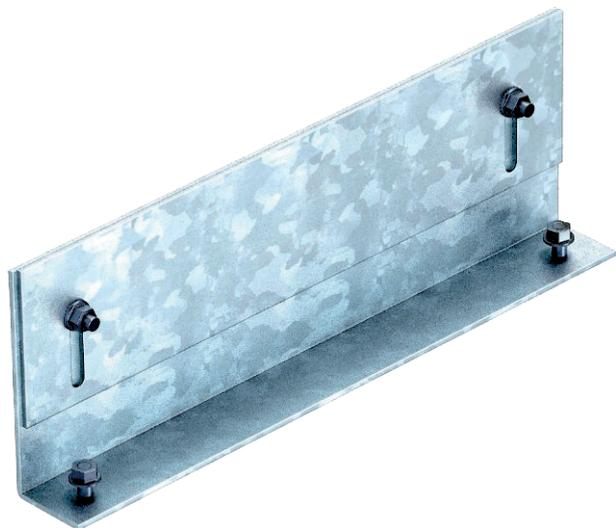
Торцевая заглушка кабельного канала состоит из боковой стенки и регулируемого по высоте бокового профиля, для универсальной установки с левой или с правой стороны канала.
