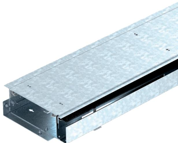
Секция кабельного канала для прокладки кабеля и монтажа электроустановочных изделий. Секция состоит из основания кабельного канала с двумя крышками, регулируемой по высоте щеточной планки и стыковочного профиля. В комплект входят два уплотнителя крышки и соединитель; для регулирования высоты необходимо шесть регулируемых опор.
