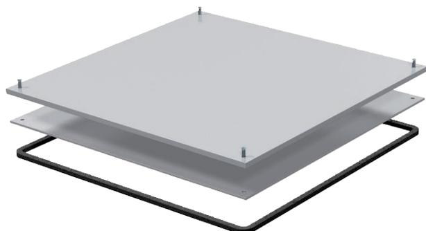
Кассетная рамка с выемкой для напольного покрытия, для установки в монтажном основании UZD350-3, для применения в сухих помещениях с сухим или влажным типом уборки, для твердых напольных покрытий толщиной 4 мм. В комплекте с заглушкой, кольцевым уплотнителем для шумоизоляции, винтами из нержавеющей стали V2A для крепления заглушки.
