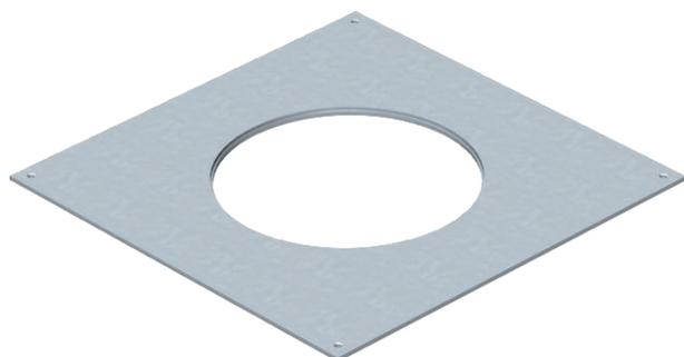
Крышка для монтажных оснований UZD350-3 для установки круглого лючка номинального размера R4. Монтажное отверстие, заглубленное на 3 мм, для последующего закрытия заглушкой.
