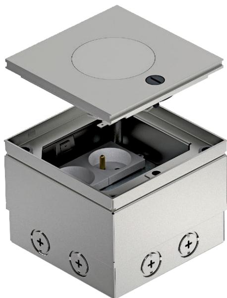
Квадратный лючок для установки в стяжке и в фальшполу с сухим типом уборки пола. Вывод кабеля через регулируемый по высоте тубус. Корпус со штампованными отверстиями для ввода труб (M25). Верхняя часть выравнивается по поверхности напольного покрытия с помощью 4-х регулируемых опор. Минимальная монтажная глубина составляет 110 мм, диапазон регулирования + 20 мм.
