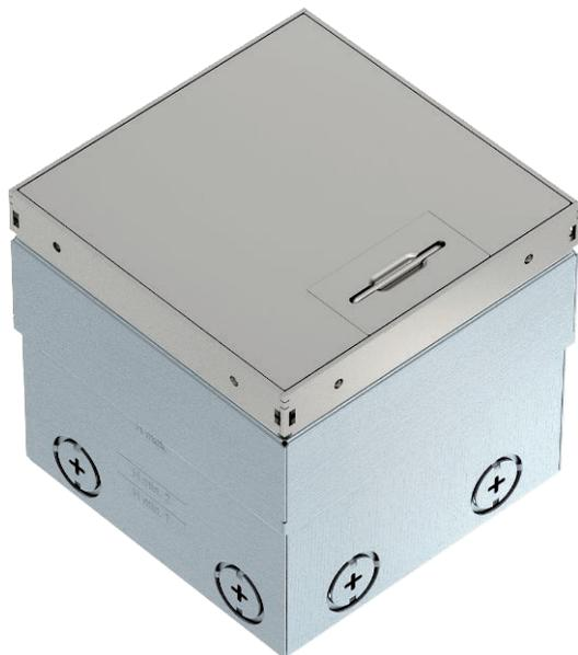
Квадратный лючок для установки в пустотном полу и стяжке с сухим типом уборки. Встроенный корпус со штампованными отверстиями для ввода труб (M20/M25). Верхняя часть выравнивается по поверхности напольного покрытия с помощью 4-х регулируемых опор. Минимальная монтажная глубина составляет 100 мм, диапазон регулирования по высоте + 35 мм.
