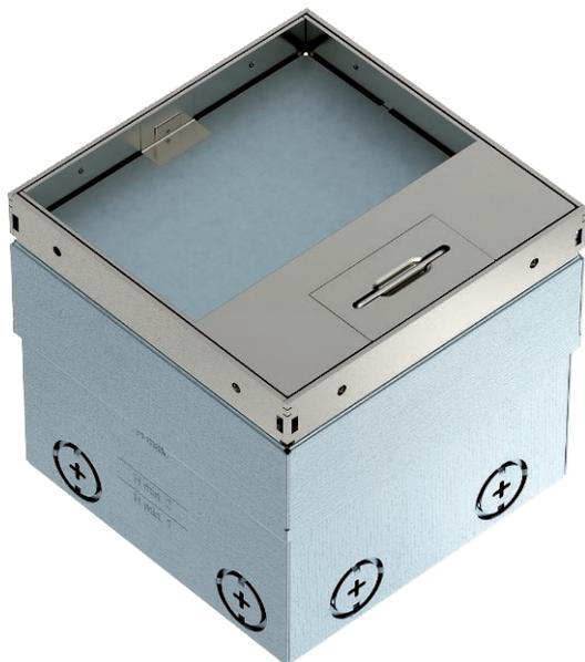
Квадратный лючок для установки в пустотном полу и стяжке с сухим типом уборки. Встроенный корпус со штампованными отверстиями для ввода труб (M20/M25). Верхняя часть выравнивается по поверхности напольного покрытия с помощью 4-х регулируемых опор. Минимальная монтажная глубина составляет 110 мм, диапазон регулирования + 25 мм. Видимая в напольном покрытии рамка и крышка из нержавеющей стали.
