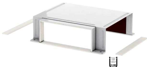
Крышка для закрытия T-образного соединения трех огнестойких кабельных коробов BSKM 1025. В комплекте с уплотнительной лентой для закрытия швов, уплотнителем для монтажа в комбинации с опорой, а также болтами для уравнивания потенциалов.
