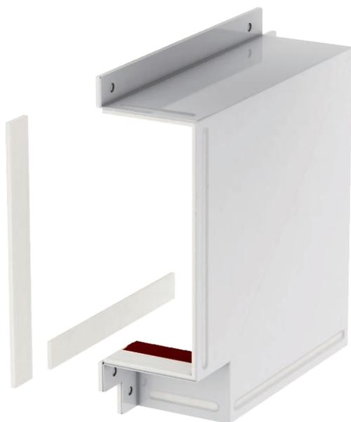
Крышка плоского угла для огнестойкого кабельного короба BSKM 1025, применяется при прямом настенном и потолочном монтаже. В комплекте с уплотнительной лентой для закрытия швов, уплотнителем для монтажа в комбинации с опорой, а также болтами для уравнивания потенциалов.
