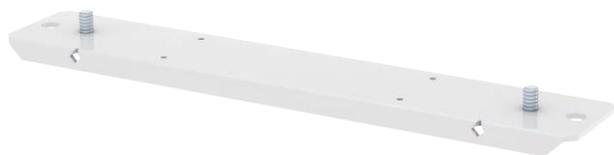
Опора для подвешенного монтажа огнестойкого кабельного короба BSKM 1025, для монтажа с помощью двух стержней с резьбой M10, а также в качестве опоры для уплотнения стыков, в комплекте с гайками.
