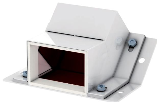
Вертикальная угловая секция восходящая, для монтажа вертикальных ответвлений при подвесном монтаже огнестойкого кабельного канала BSKM 0711, для крепления стержней с резьбой M10, в комплекте с уплотнителями и гайками, а также болтами для уравнивания потенциалов.
