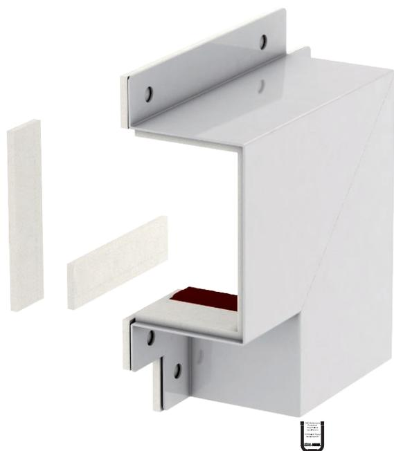
Крышка плоского угла для огнестойкого кабельного короба BSKM 07 11, применяется при прямом настенном и потолочном монтаже. В комплекте с уплотнительной лентой для закрытия швов, в комбинации с пластиной применяется с уплотнителем, в комплекте с болтами для уравнивания потенциалов.
