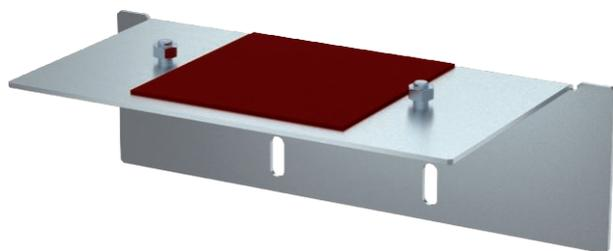
Опора/адаптерная пластина для подвешного монтажа соединителя для настенного монтажа BSKM-WA 0711, для крепления с помощью стержней с резьбой M10, в комплекте с гайками.
