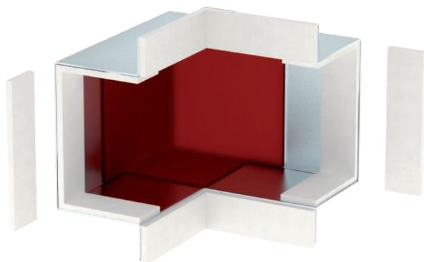
Крышка внешнего угла для огнестойкого кабельного короба BSKM 0711, применяется при прямом настенном и потолочном монтаже. В комплекте с уплотнительной лентой для закрытия швов, уплотнителем для монтажа в комбинации с опорой.
