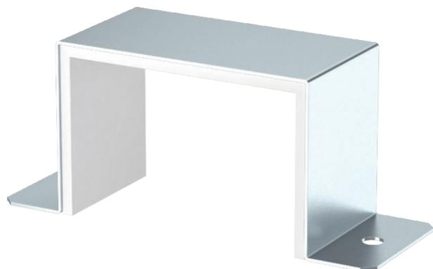
Соединитель с интегрированным уплотнителем для огнестойкого кабельного короба BSKM 0711, применяется для соединения и герметизации стыков кабельного короба. Применяется при минимальном расстоянии 30 мм между боковой стенкой короба и потолком или стеной. В комбинации с кронштейном применяется уплотнитель.
