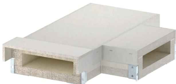
T-образная секция для огнестойкого кабельного короба BSKH, класс огнестойкости I90/E30, согласно DIN 4102 часть 11 и часть 12, для установки в монтажных системах OBO. Для крепления фасонных деталей рекомендуется применение дополнительных кронштейнов. В комплекте с соединителями, установленными на обоих концах короба, и 3 уплотнительными лентами длиной 1 м и соединительными болтами.
