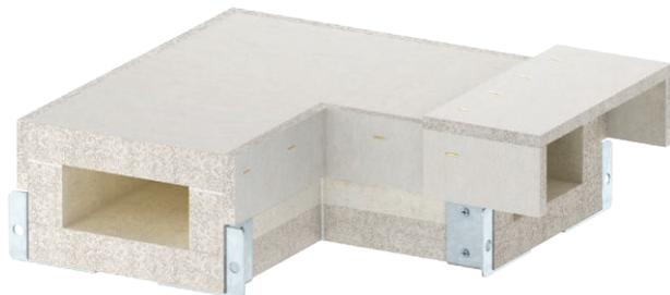
Угловая секция 90° для огнестойкого кабельного короба BSKH, класс огнестойкости I90/E30, согласно DIN 4102 часть 11 и часть 12, для установки на монтажных системах OBO. Для крепления фасонных деталей рекомендуется применение дополнительных кронштейнов. В комплекте с соединителями, установленными на обоих концах короба, и 3 уплотнительными лентами длиной 1 м и соединительными болтами.
