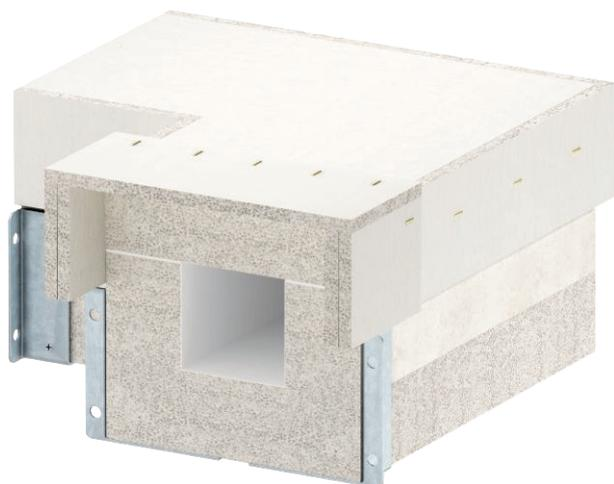
Горизонтальная угловая секция 90° для огнестойкого кабельного короба BSKHF-0808 из водо- и морозостойкого легкого бетона, армированного стекловолокном класса А1 согласно EN 13501 (часть 1) для установки на монтажных системах ОБО. В комплект входят соединители, установленные на обоих концах короба, соединительные болты и уплотнительная лента. Для крепления фасонных деталей рекомендуется применение дополнительных кронштейнов.
