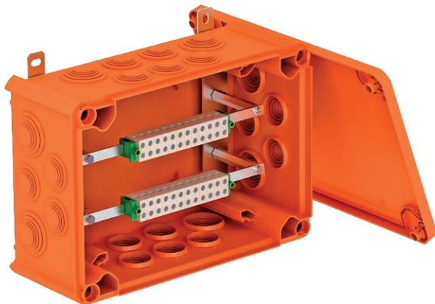
Не содержащая галогенов кабельная распределительная коробка с установленными мягкими вставными уплотнителями, с допуском для повышения живучести конструкций согласно DIN 4102 часть 12. Классы огнестойкости от E30 до E90
