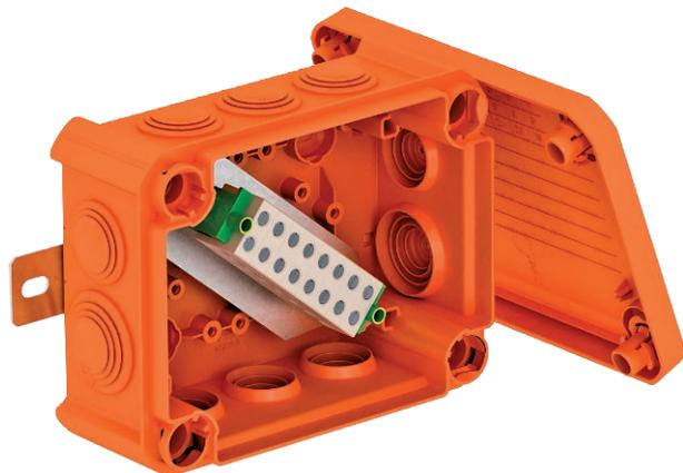
Не содержащая галогенов кабельная распределительная коробка с установленными мягкими вставными уплотнителями, разрешенная для повышения живучести электрических конструкций согласно DIN 4102, часть 12. Классы огнестойкости от E30 до E90
