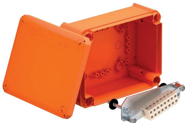
Не содержащая галогенов кабельная распределительная коробка, разрешенная для повышения живучести электрических конструкций согласно DIN 4102 часть 12. Классы огнестойкости от E30 до E90
