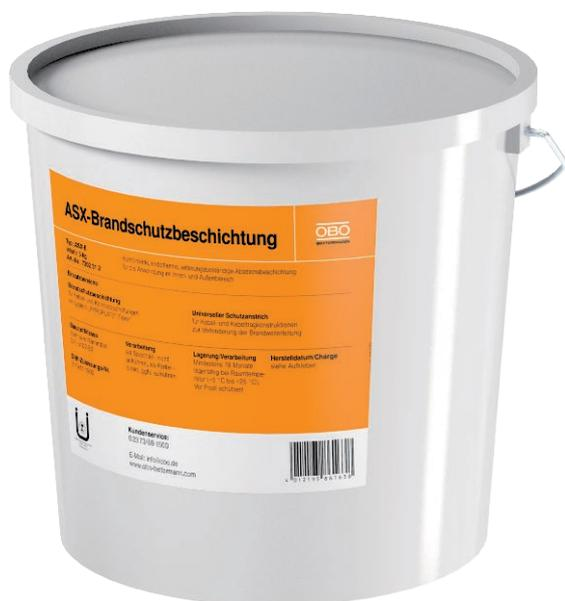
Комбинированное, эндотермическое и стойкое к атмосферным воздействиям покрытие для внутренних и наружных работ. Универсальное защитное покрытие для кабельных и кабеленесущих конструкций. Использование в качестве шпатлевки. Хватит для площади 4 м<sup>2</sup>. Класс строительных материалов DIN 4102 – B2 нормально воспламеняющийся. Покрытие рекомендуется хранить вертикально в сухом теплом помещении при температуре от +5°C до +25°C в закрытой оригинальной упаковке, срок хранения до 18 месяцев.
