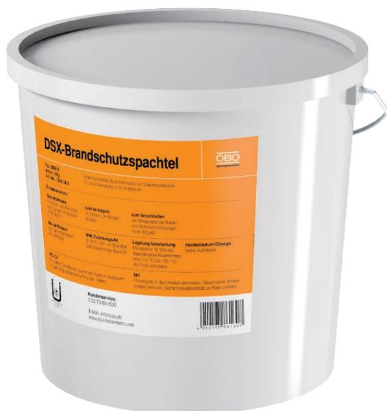
Огнестойкая шпатлевка на дисперсионной основе для работ внутри помещений, для заполнения остаточных стыков и для заделки отверстий. Разрешенный строительный материал для заделки просверленных отверстий при вводе отдельных кабелей. Класс строительных материалов DIN 4102 – B2 нормально воспламеняющийся. Шпатлевку рекомендуется хранить вертикально в сухом теплом помещении при температуре от +5°C до +25°C в закрытой оригинальной упаковке, срок хранения до 18 месяцев.
