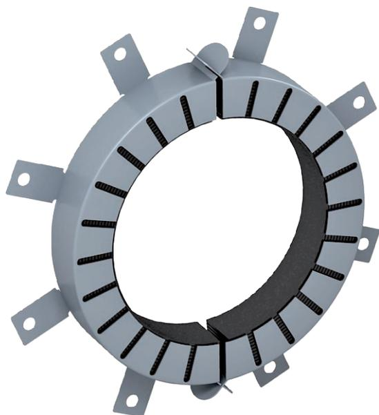
Манжеты для горячих труб. В случае пожара огнестойкий материал, расположенный в стальном корпусе манжеты, уплотняется и плотно перекрывает трубу из термопласта. Крепление манжеты осуществляется с помощью дюбелей или стержней с резьбой М8.
